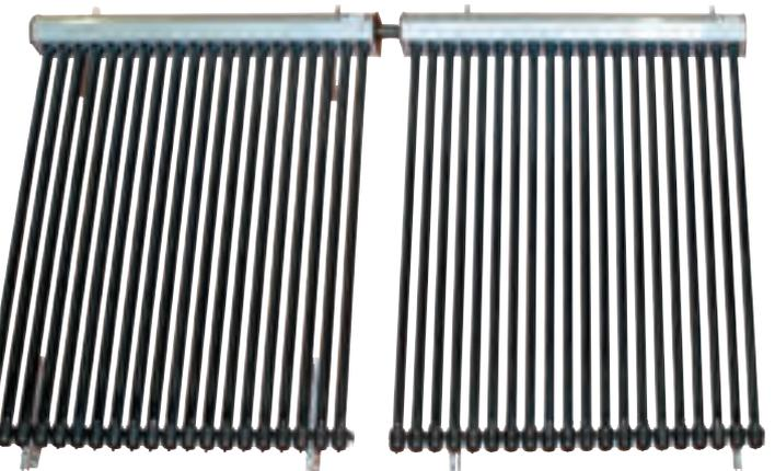
In der Kondensationskammer wird die Wärme an das Solarfluid übertragen, welches durch das Sammlerrohr zirkuliert. Dabei kondensiert der Dampf und die Flüssigkeit fließt innerhalb des Verdampferrohrs wieder nach unten. Der Kreislauf beginnt von vorn. Dieser Vorgang funktioniert auch bei diffuser Strahlung. Er ist nur abhängig von der vorherrschenden Außentemperatur. Deshalb arbeiten Vakuumröhrenkollektoren auch schon bei bedecktem Himmel und damit früher und auch länger als Flachkollektoren.
